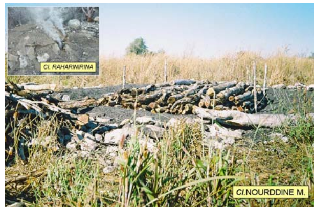
Figure 10. Du bois amassé sur une ancienne meule pour la carbonisation.
